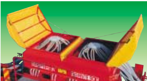
Tramoggia con due distributori sementi Hopper with two seed distributors Trémie avec deux distributeurs de semences Saatgutbehälter mit zwei Verteilerköpfen Tolva con dos distribuidores
