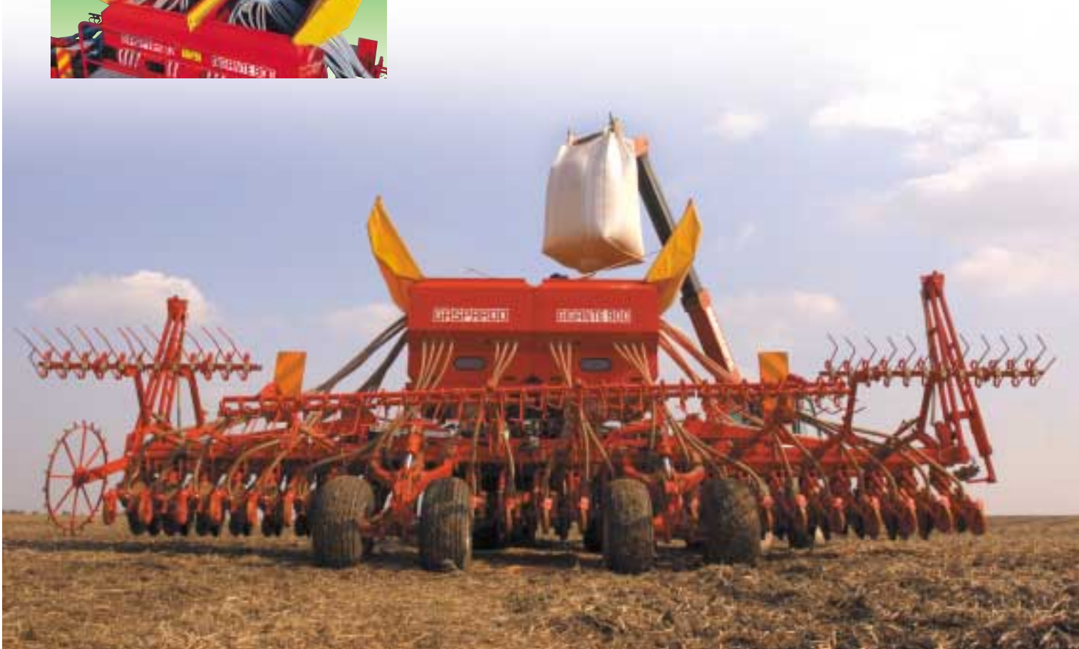
Tramoggia con due distributori sementi Hopper with two seed distributors Trémie avec deux distributeurs de semences Saatgutbehälter mit zwei Verteilerköpfen Tolva con dos distribuidores
