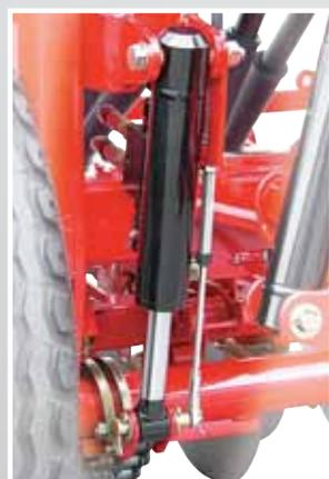
Tensado mecánico centralizado de la barra de siembra; disponible a pedido con mando hidráulico.
