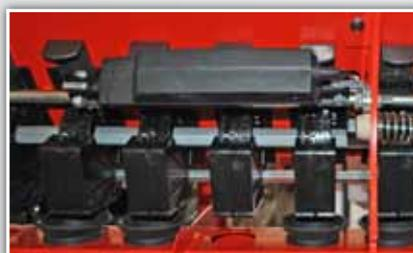
Sistema eléctrico tramline para bloquear los distribuidores requeridos con un mando eléctrico desde la cabina.
