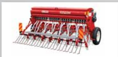
El distribuidor combinado semilla/fertilizante tiene una doble cámara de material plástico. Esto evita los fenómenos de corrosión y desgaste debidos a los agentes atmosféricos y químicos, aumentando notablemente la vida útil del sistema y reduciendo las necesidades de mantenimiento. El distribuidor de semillas cuenta con un palpador de muelle para reducir al mínimo el daño de la semilla y mantener su máxima capacidad de germinación.
