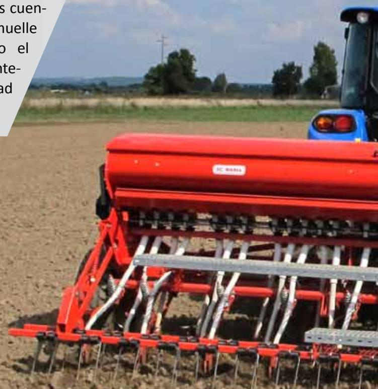
El distribuidor de semillas está compuesto por diferentes elementos para trabajar de la mejor manera, tanto con semillas pequeñas como con semillas de mayores dimensiones. El palpador de muelle permite obtener un tratamiento delicado de las semillas, preservando al máximo su vitalidad y, por ende, la homogeneidad de la distancia de plantación.
