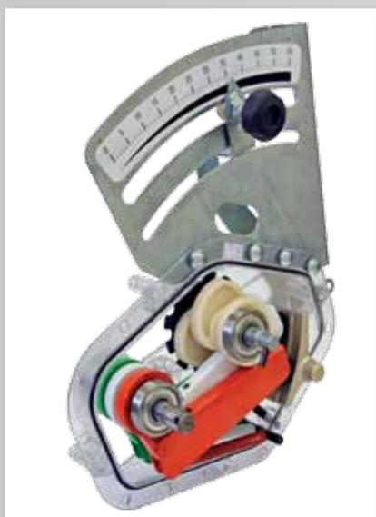
Nuestro cambio de 3 levas permite que la transmisión del movimiento sea uniforme y constante. Con el uso de los cojinetes de bola se obtiene una mayor resistencia al desgaste de los ejes de transmisión. El cambio es de tipo de baño de aceite con mirilla de inspección. La calibración del cambio es rápida y precisa.
