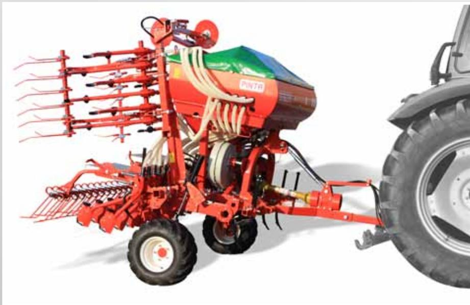
Todos los modelos **PINA** y **PINTA** se encuentran ambos disponibles en versión transportada o remolcada. La utilidad de la versión remolcada, adecuada para combinarse con tractores de dimensiones reducidas, puede apreciarse mayormente en los terrenos de colina, y cuenta con borrahuellas y elevación en las ruedas para el transporte.
