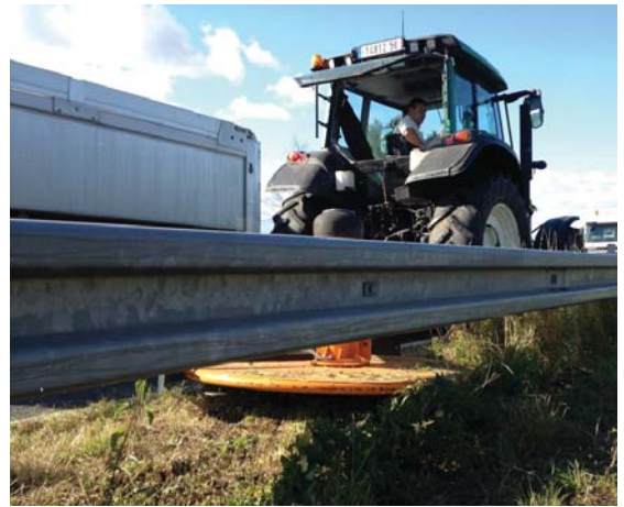
Control hidráulico de recuperación (regulable).
